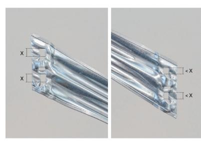
Notez la différence de hauteur entre la connexion supérieure et inférieure de la diagonale. Voir ci-contre « < X ». Le sommet est légèrement plus long pour agir comme guide lors du montage, il aide à donner le bon angle pendant l'assemblage.
