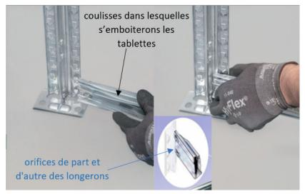
Insérez les longerons à l'arrière du rayonnage en faisant bien attention que les deux orifices du longeron s'insèrent parfaitement dans les crevées du montant de l'échelle.
