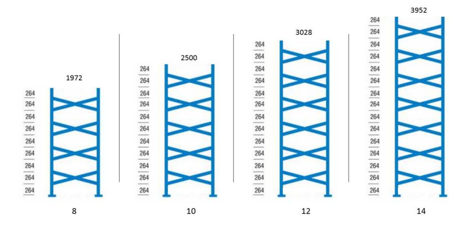
Schema diagonalen bij gebruik van juksluitingen / Montage des entretoises en cas d'échelles fermées
